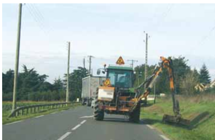
La présence d'un chantier mobile peut perturber momentanément la circulation et engendrer des comportements dangereux chez les automobilistes : on voit ici un camion bloqué dans un convoi de fauche effectuer un dépassement de l'engin de tête.
