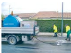
Utilisation du désherbeur thermique Waipuna. Mousse obtenue à partir d'un mélange d'eau, d'amidon de maïs et de noix de coco, Waipuna France
