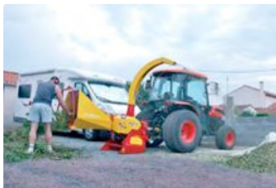
Fabrication de copeaux de feuillus à l'aide d'un broyeur xylomix, Rabaud
