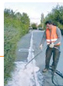
Utilisation du désherbeur thermique Waipuna. Mousse obtenue à partir d'un mélange d'eau, d'amidon de maïs et de noix de coco, Waipuna France
