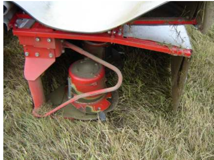
Les couteaux articulés sur un axe vertical
