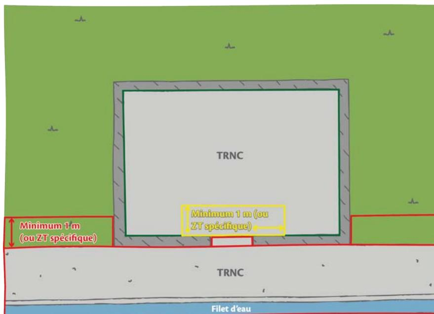
**Schéma 4 – Cas d'un TRNC sans pente longeant un TRNC relié à un filet d'eau, avec la présence d'un mur d'enceinte**
